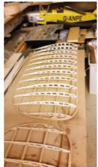
Die Tragflächen entstanden in klassischer Rippenbauweise
