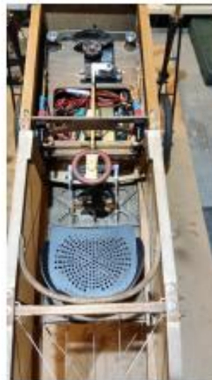
Die RC-Anlage ist direkt vor dem Cockpit versteckt
