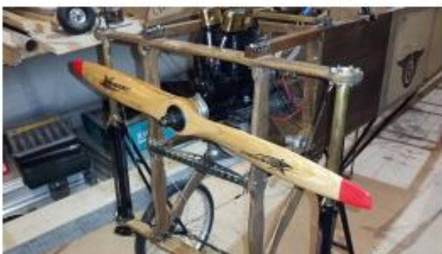
Für den Vortrieb sorgt ein Einzylinderviertaktmotor von Saito
